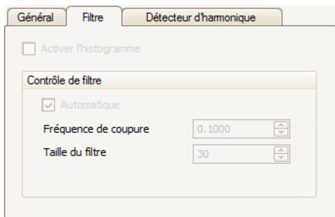
**Contrôle de filtre** Le PicoScope peut procéder à un filtrage passe-bas des statistiques pour produire des chiffres plus stables et plus précis. Le filtrage n'est pas disponible pour tous les types de mesure.
