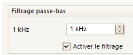
**Filtrage passe-bas.** Un [filtre passe-bas](#) numérique indépendant pour chaque voie d'entrée, avec fréquence de coupure programmable. Cette option peut être utile pour supprimer tout bruit de votre signal afin de réaliser des mesures plus précises. Pour connaître les disponibilités, voir le [tableau des fonctions des oscilloscopes](#).
