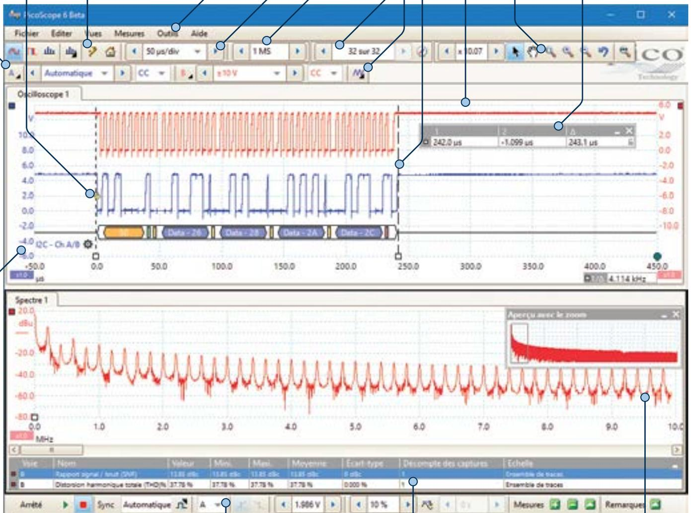
**Axes mobiles :** les axes verticaux peuvent être déplacés vers le bas et le haut. Cette fonction est particulièrement utile lorsqu'une forme d'onde en cache une autre. Il existe également une commande d'axes à positionnement automatique.
